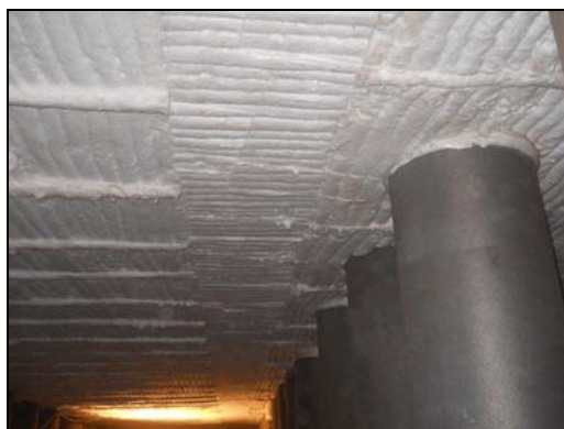
Módulos PYROFOLD en bóveda de horno de planta siderúrgica
