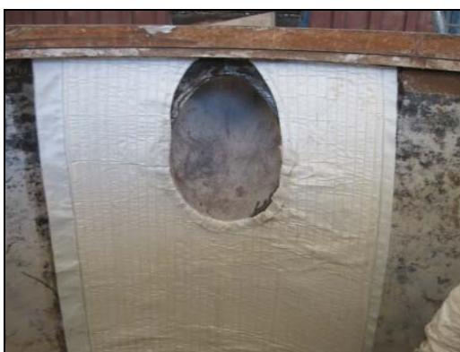
Aislación microporosa BTU BLOCK flexible en cuchara de transporte de aluminio
